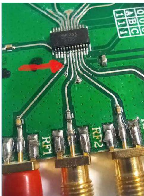
l'integrato mette tensione sui pin delle entrate e quindi con il lavoro del diodo si crea un corto.
