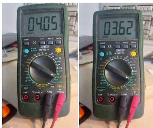
Provo anche invertendo le polarità per verificare la bidirezionalità. Funziona anche così. Tutto OK. Così ho modo di testare se la saldatura è riuscita. Per impratichirmi riprovo l'intera procedura su altre piste. Va bene, è un poco difficile ma ce la posso fare.
