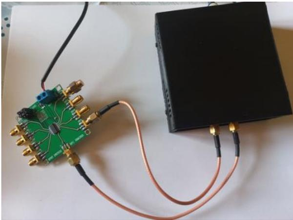
Per prima cosa taro lo strumento con le sue utilities, per settarne la linearità e successivamente faccio un test iniettando il segnale a 0dB con uno sweep da 35MHz a 2GHz, in 3 varianti: integrato non alimentato, integrato alimentato e porta selezionata, integrato alimentato e porta non selezionata.
