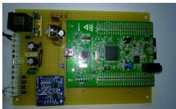
modulare di tele-gestione (STS - Sistema Tele-gestione Siti) che utilizza un RTX IC2 per la comunicazione via Packet in VHF; l'STS fornisce dati di telemetria e permette di gestire le batterie e un carico;
