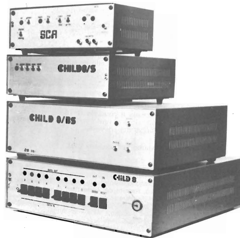
Ecco una bella immagine che raffigura diversi apparecchi della serie CHILD. Alla base la prima versione; sopra, il modello BS (quello definitivo di cui è oggetto l'articolo); ancora sopra, il piccolo /S, e in cima alla pila lo SCA, l'adattore che permette di memorizzare dati e programmi su un qualunque registratore.
